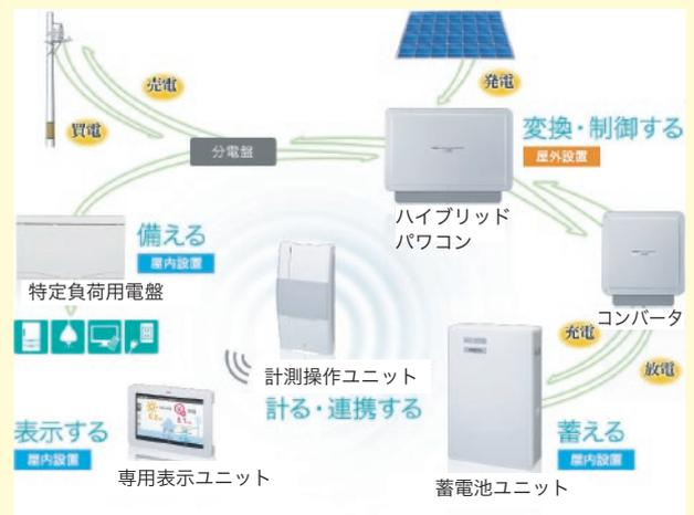
パワコンは、単なる変換器から直流で蓄電池に蓄電するため、ハイブリッド化が進んで効率化しています。単なる蓄電池よりも、発電システム全般をコントロールすることが可能です。
